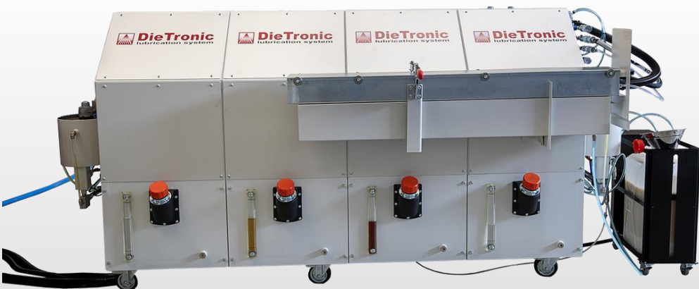
Soluzione 1 – Unità esterna di pulizia su carrello integrata a lato dei serbatoi dell'olio
